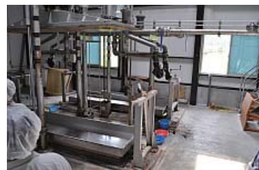
パイプラインで送られた原料もろみを絞る機械
